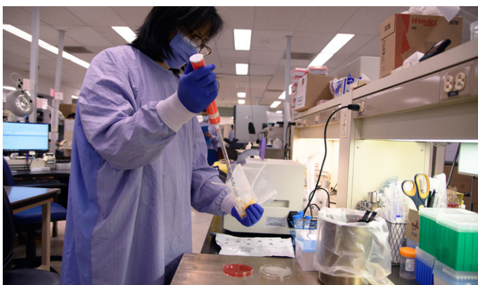
Nagsasagawa ang VCH ng antimicrobial testing sa isang copper sample sa medical microbiology lab ng Vancouver General Hospital.
