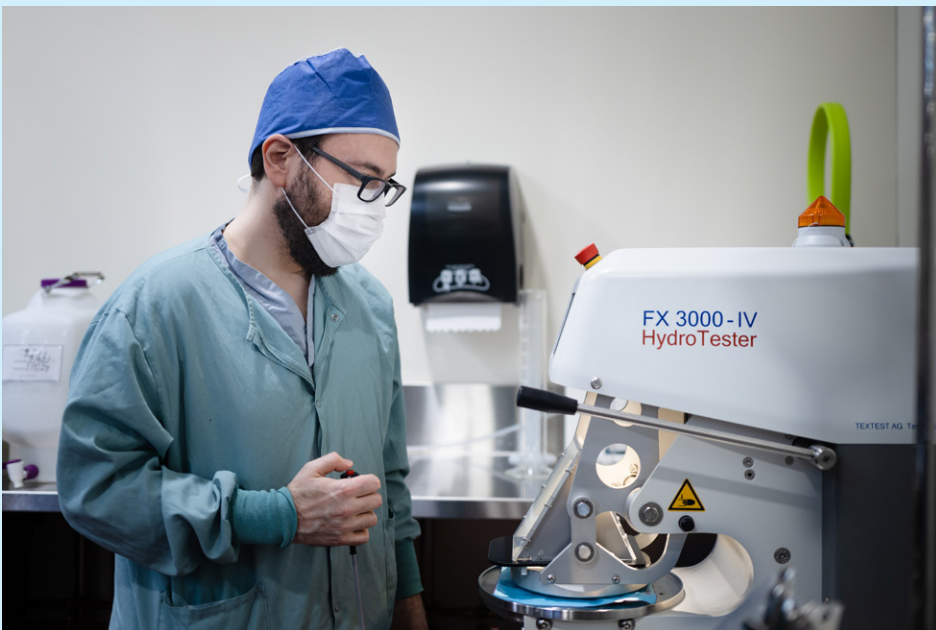
Pag-test sa water resistance: hydrostatic pressure
